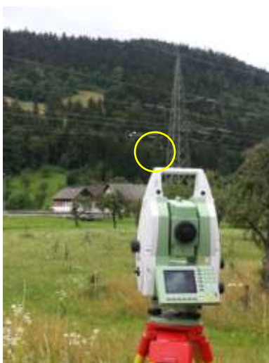
Slika 1. Postavitev merilne postaje LEICA TS30 (obkrožena rumeno sta OTLM napravi)
